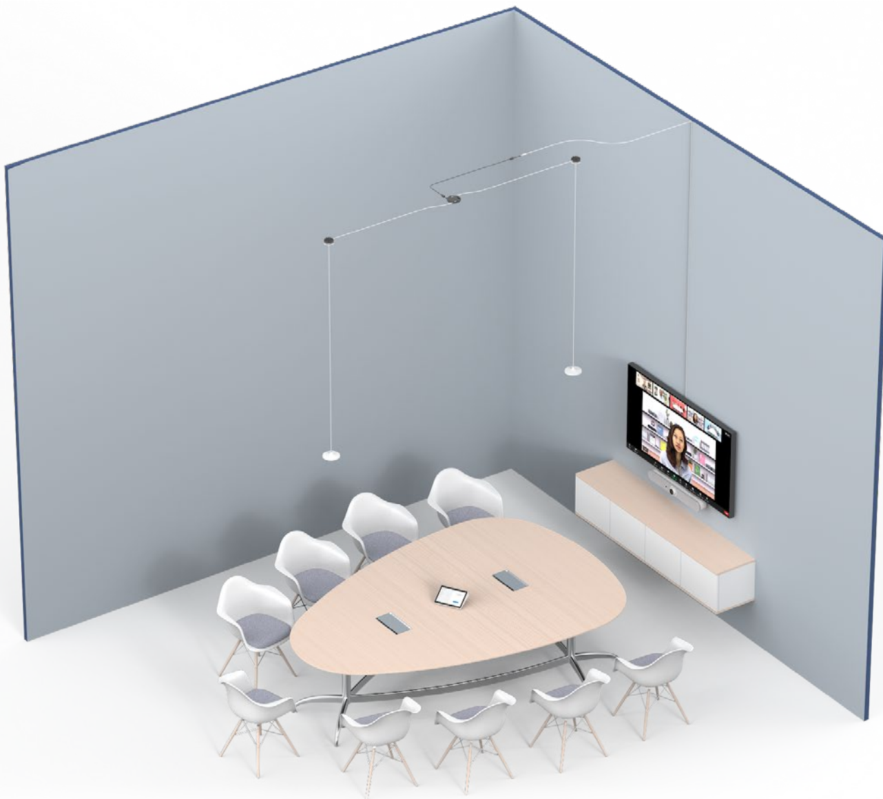
图 2 - 两个麦克风和吊装配件。两个麦克风都连接到麦克风集线器，后者通过 CC5000e 麦克风延长线进行连接。麦克风相距 2.4 米（8 英尺），麦克风集线器位于中间，以充分利用线缆。注意：图片未按比例缩放。
