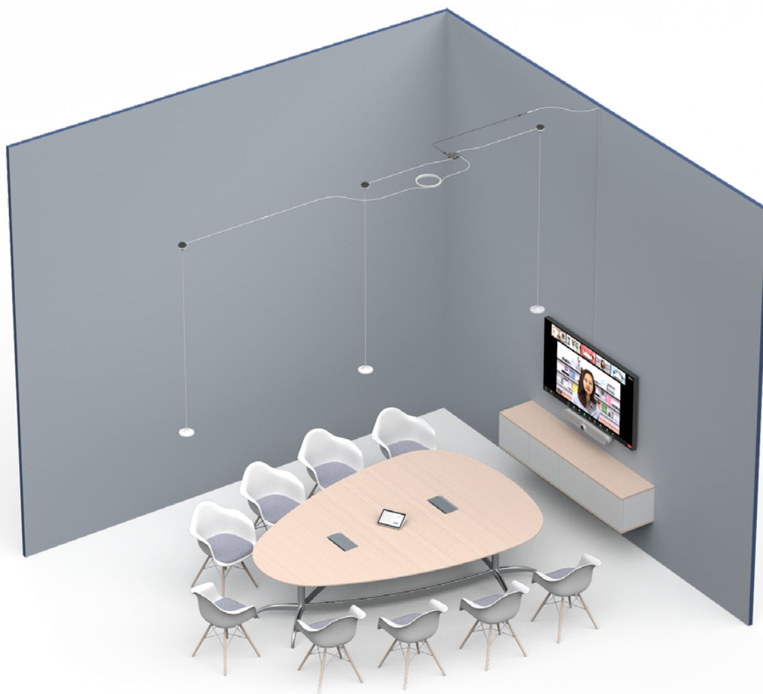
图 3 - 三个麦克风和吊装配件。前两个麦克风连接至麦克风集线器，后者通过 CC5000e 麦克风延长线连接至 CC5500e/CC4500e 系统。第三个麦克风通过延长线连接到麦克风集线器。麦克风相距 2.4 米 (8 英尺)，麦克风集线器位于前两个麦克风的中间，以充分利用线缆。注意：图片未按比例缩放。
